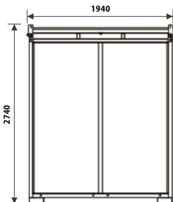
平面図 柱外寸法
